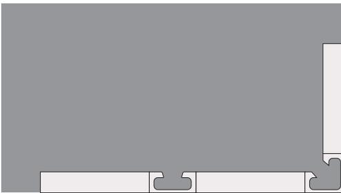
Fixez les éléments à l'aide des fixations fly caisse en tournant la poignée de serrage
