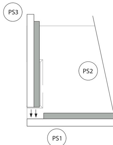
1- Positionner/Coller la pièce PS3 à l'angle des pièces PS1 et PS2.
