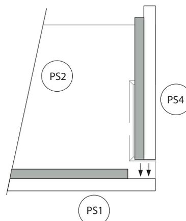
1- Positionner/Coller la pièce PS4 à l'angle des pièces PS1 et PS2.
