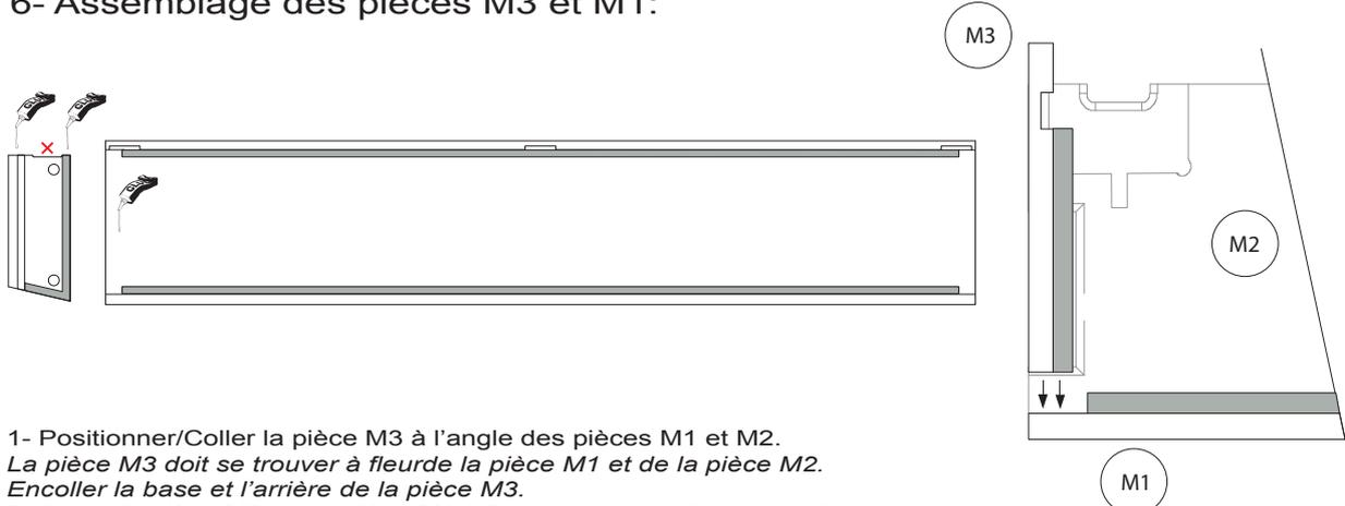
1- Positionner/Coller la pièce M3 à l'angle des pièces M1 et M2.
