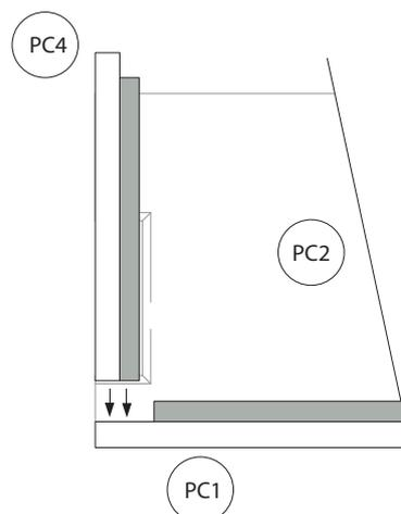
1- Positionner/Coller la pièce PC4 à l'angle des pièces PC1 et PC2.
