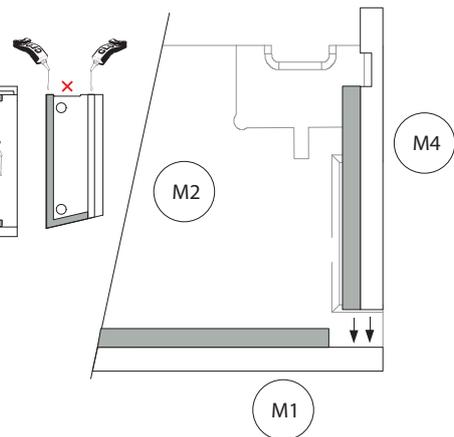
1- Positionner/coller la pièce M4 à l'angle des pièces M1 et M2.
