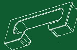
Pièce PS8 X2 (L:760mm / l: 115mm / ep:18mm)
