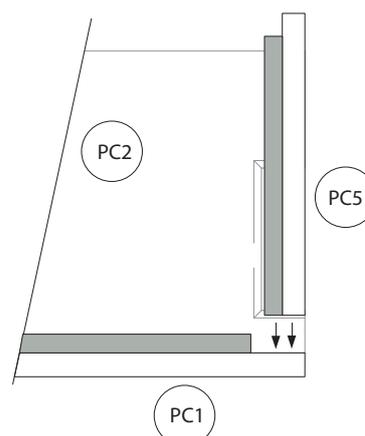
1- Positionner/Coller la pièce PC5 à l'angle des pièces PC1 et PC2.
