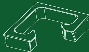
Pièce PC8 X8 (L:78mm / l: 170mm / ep:18mm)
